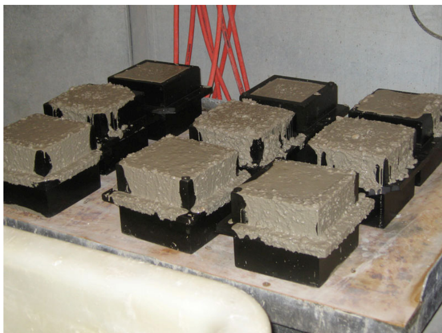
Afbeelding 3.1: De drukkubussen gestort in de mallen
